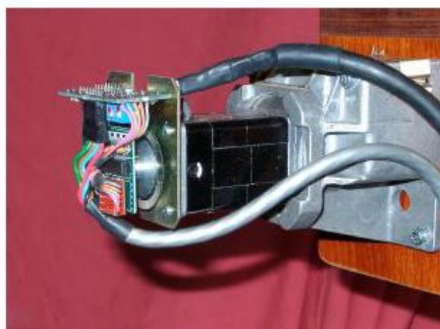
Рисунок 4.3 – Маленький сервомотор DC с энкодером (слева) и редуктором
